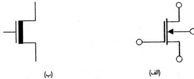
شکل ۵-۱۱: (الف) نماد مداری MOSFET کاهشی کانال N ، (ب) نماد ساده شده
